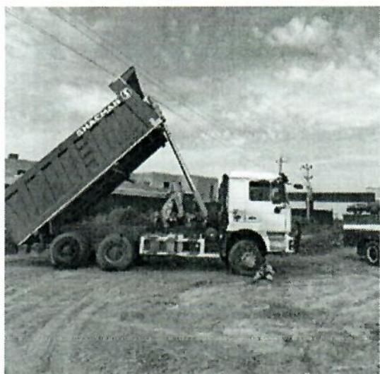
При выезде с территории стройплощадки грузового автомобиля марки SHACMAN с поднятым кузовом водитель допустил приближение кузова автомобиля на расстояние менее допустимого к проводам ВЛ 10 кВ (смертельный исход, повреждение техники)
